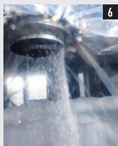
5 混雑していたラベルとPETボトルを粉砕してフレックに。6 フレックはアルカリ洗浄で加水分解させ表面の汚れを削り取ります。
