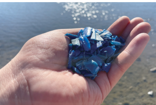
清掃ボランティアによって回収された海洋ごみを粗破碎したプラスチック。ここから再生されたペレット(表紙写真)を原料に、買い物かごにアップサイクルされます。
