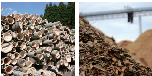
伐採された竹を製紙原料とするにはチップ化工程が必要(画像提供/西村氏)。輸送効率の悪い空洞の竹を作業用軽トラックで運ぶ、硬い竹を切削するためにチップの刃を見直すなど、初めてのことばかりのなか取り組みは地域と一体となって進められました。
