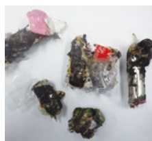
発火原因となったリチウムイオン電池
