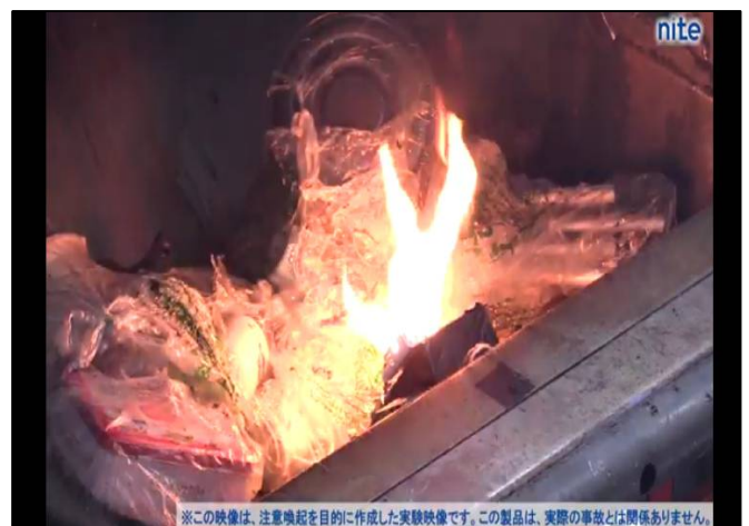
パッカー車の回転板で押しつぶされ、火が出る様子
