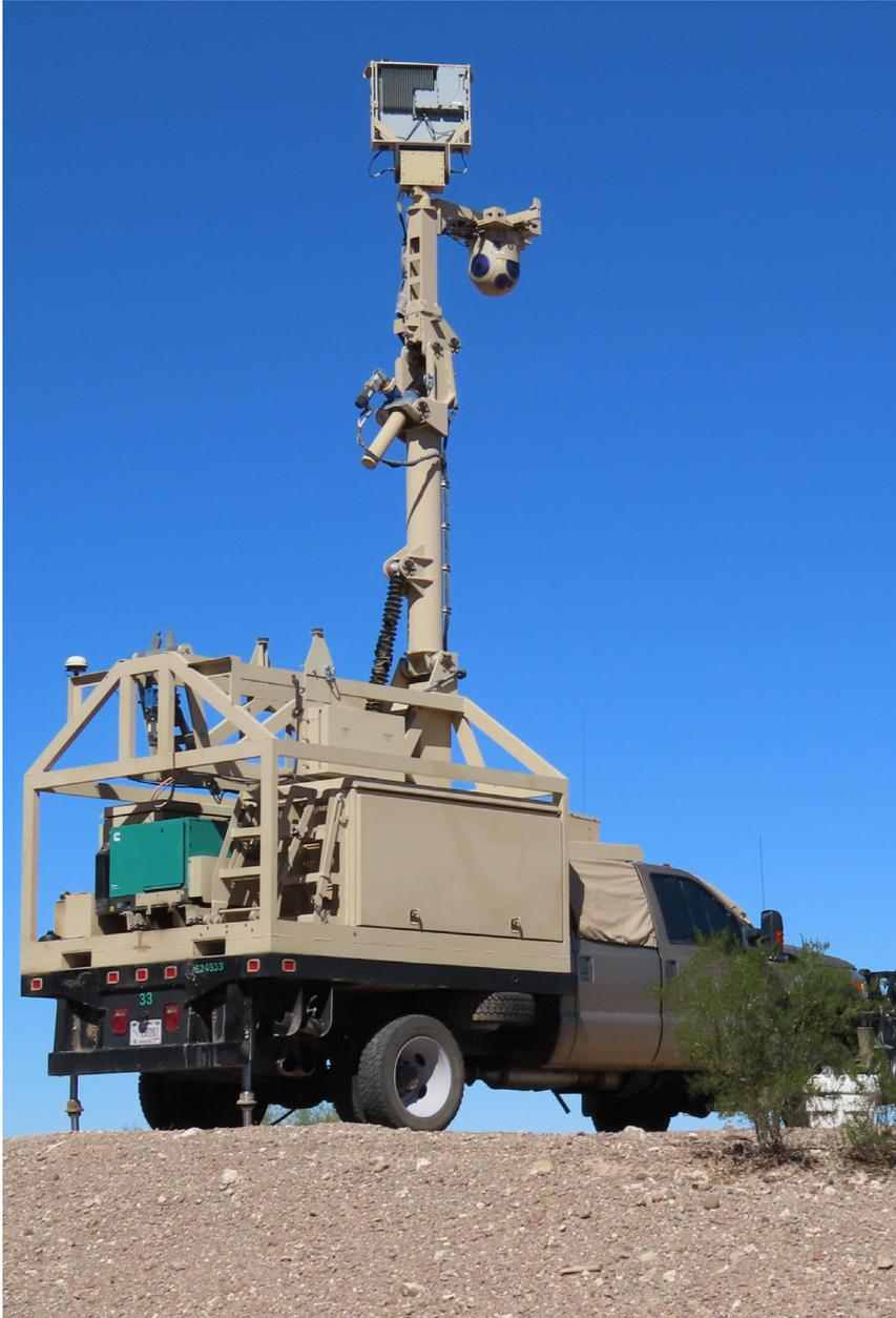
Una unidad de Capacidad de Vigilancia Móvil (MSC) en el condado de Pima, Arizona. Este modelo fabricado por FLIR se denomina a veces Sistema Móvil de Videovigilancia (MVSS). Fuente: EFF.
