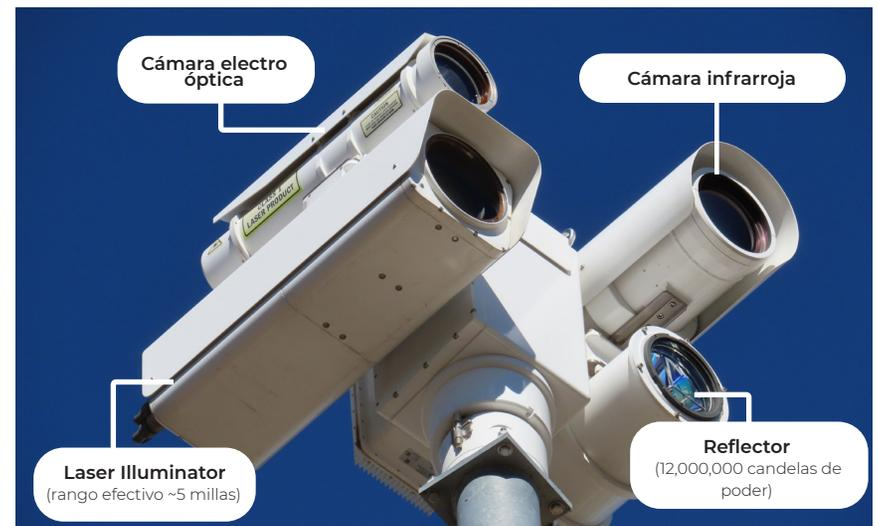
Detalle de sensores RVSS. Fuente: EFF.
