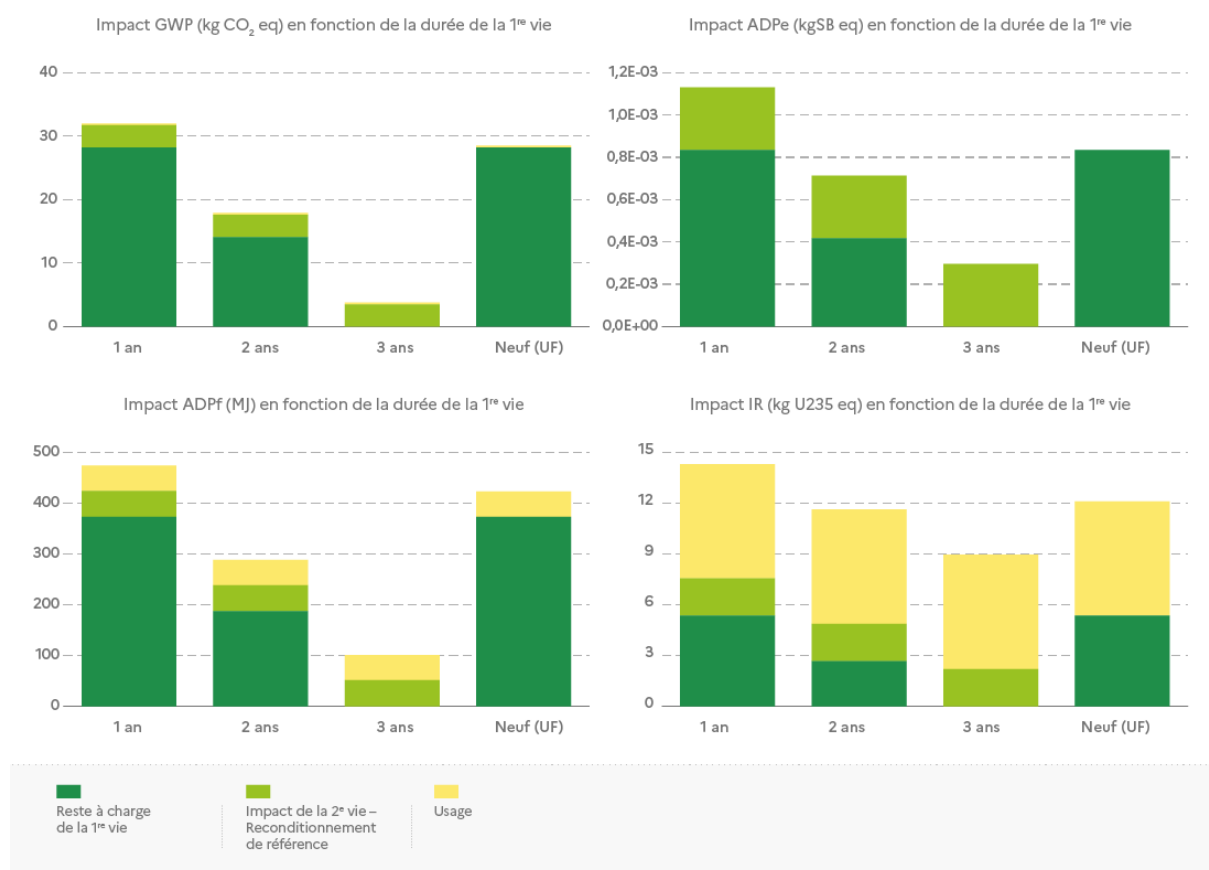
Figure 26 – Comparaison smartphone - Approche par amortissement – Variation de l'impact environnemental en fonction de la durée de première vie.
