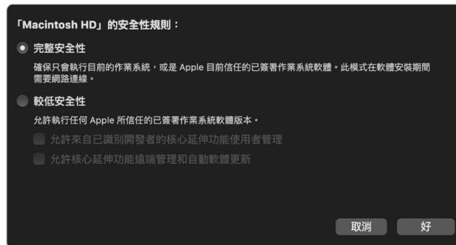
比起典型的全域簽章作法，使用線上簽署伺服器也能更有效防禦回復攻擊。在全域簽署系統中，安全性 epoch 可能已更新過很多次，但從未見過最新版軟體的系統無從得知。例如，即使目前實際的安全性 epoch 為 5，目前認為屬於安全性 epoch 1 的電腦，仍可接受安全性 epoch 2 的軟體。透過 Apple 晶片線上簽署系統，簽署伺服器可拒絕為並非屬於最新安全性 epoch 的軟體建立簽章。
