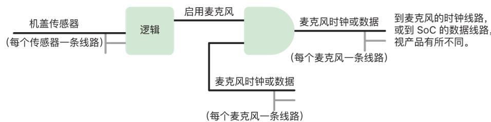
每款支持硬件切断麦克风的产品都有一个或多个机盖传感器, 可通过用户交互的某些物理属性 (如霍尔效应传感器或铰链角度传感器) 检测到机盖或保护壳以物理方式盖上的行为。对于需要校准的传感器, 其参数会在设备的生产过程中设定, 校准过程还会包括不可逆的硬件锁定, 以阻止对传感器上敏感参数的任何后续更改。这些传感器会发出直接的硬件信号, 该信号会通过一组简单的不可重新编程的硬件逻辑。此逻辑会在停用麦克风前提供防抖、滞后和/或最高 500 毫秒的延迟。根据产品的不同, 此信号可通过停用麦克风和片上系统 (SoC) 之间用于传输数据的线路来实现, 或停用连接到麦克风模块上允许其启用的其中一个输入线路来实现, 如时钟线路或类似的有效控制。
