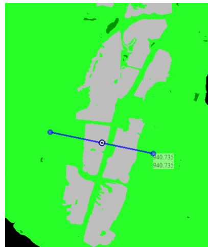
Mise à plat d'étangs de plus d'un hectare dans le département du Pas-de-Calais (Conchil-le-Temple) dans le MNT produit à partir d'acquisitions LiDAR. Sur le masque source 6 , à droite, les nœuds du MNT LiDAR situés dans ces surfaces d'eau sont codés en points fictifs (69 si acquisition IGN, 99 si acquisition externe).
