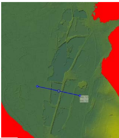
Mise à plat d'étangs de plus d'un hectare dans le département du Pas-de-Calais (Conchil-le-Temple) dans le MNT produit à partir d'acquisitions LiDAR. Sur le masque source 6 , à droite, les nœuds du MNT LiDAR situés dans ces surfaces d'eau sont codés en points fictifs (69 si acquisition IGN, 99 si acquisition externe).
