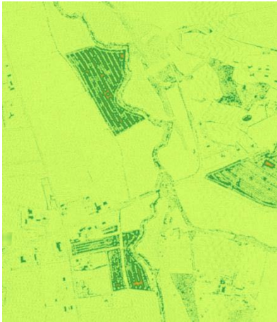
Extrait du RGE ALTI® LiDAR (masque distance) le long de la Petite Baïse. La distance d'interpolation est ici faible (figurée par des nuances de vert donc inférieure à 10m).
