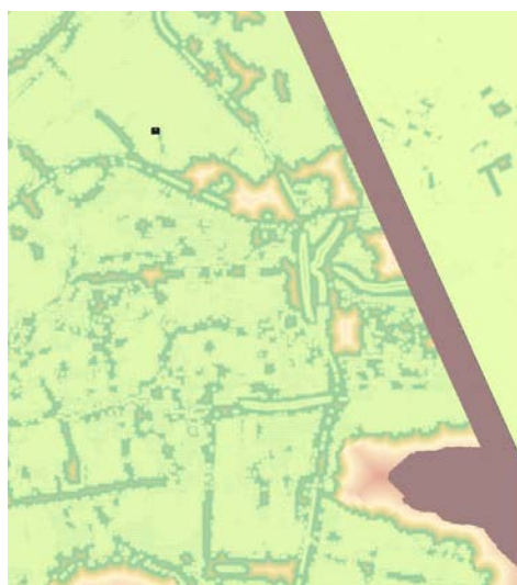
Extrait du masque Distance : les nœuds de la bande raccord sont codés à 254.
