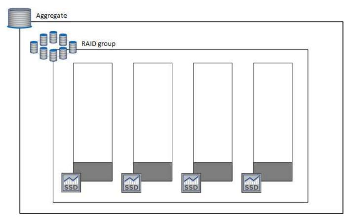
Lorsque BlueXP crée un agrégat, il commence par un groupe RAID. Si de la capacité supplémentaire est nécessaire, BlueXP augmente l'agrégat en augmentant de la même quantité la capacité de tous les disques du groupe RAID. L'augmentation de la capacité est soit un minimum de 256 Gio, soit 10 % de la taille de l'agrégat.
