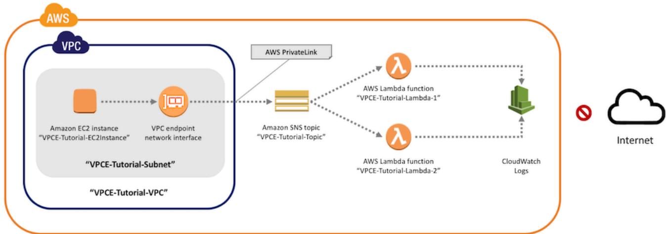
このネットワークは、Amazon EC2 インスタンスを含む VPC で構成されます。インスタンスは、インターフェイス VPC エンドポイントを通じて Amazon SNS に接続します。このタイプのエンドポイントは、AWS PrivateLink を使用するサービスに接続します。この接続が確立されたら、ネットワークがパブリックインターネットから切断されている場合でも、Amazon EC2 インスタンスにログインして Amazon SNS トピックにメッセージを発行できます。このトピックは、受け取ったメッセージを、2 つの AWS Lambda サブスクリプト関数にファンアウトします。これらの関数は、受け取ったメッセージを Amazon CloudWatch Logs に記録します。
