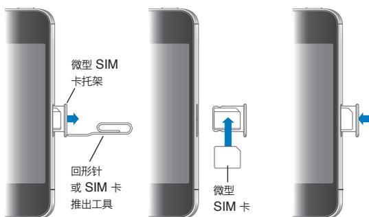
**安装 SIM 卡：** 将小回形针的一端或 SIM 卡推出工具插入 SIM 卡托架上的孔中。拉出 SIM 卡托架并将 SIM 卡放入托架中，如图所示。使 SIM 卡与托架平行，将 SIM 卡置于顶部，小心地装回托架。
