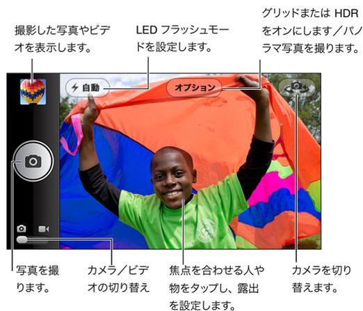
カメラが焦点を合わせて露出を設定している場所に、長方形が短時間表示されます。iPhone 4S 以降で人物の写真を撮るときは、顔検出機能により、10 人までの顔に焦点が合わせられ、それらの顔の間で露出のバランスが調整されます。検出された顔にそれぞれ長方形が表示されます。
