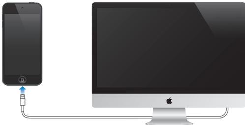
**Important** : Il est possible que la batterie de l'iPod touch se décharge si celui-ci est connecté à un ordinateur éteint, en mode de veille ou en mode de suspension d'activité.
