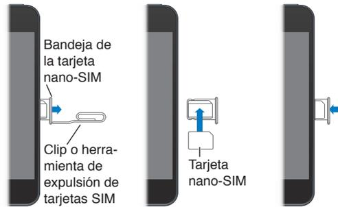
**Instalar la tarjeta SIM:** Introduzca el extremo de un clip pequeño o la herramienta de expulsión de la SIM en el orificio de la bandeja de la tarjeta SIM. Extraiga la bandeja de la tarjeta SIM y coloque la SIM en la bandeja tal como indica la ilustración. Con la bandeja alineada y la tarjeta SIM en ella, coloque de nuevo la bandeja en su lugar con cuidado.
